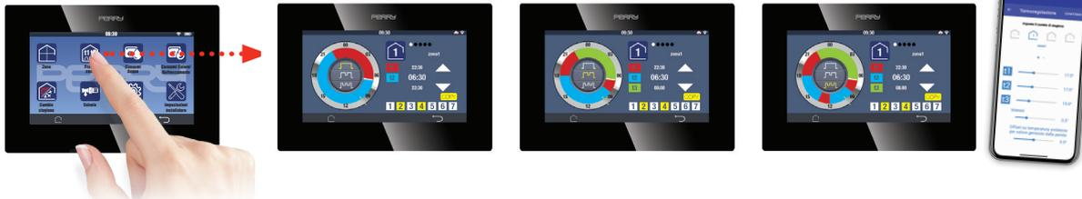
Cada zona dispone de tres niveles de temperatura personalizables, al igual que todos los parámetros de configuración del control de temperatura: histéresis, PID, offset, etc.
