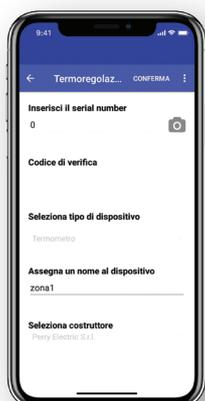
A través de la aplicación, disponible para dispositivos iOS y Android, se puede añadir una nueva zona. Basta con hacer una foto del código QR del dispositivo que se va a añadir (por ejemplo, un termómetro o un termostato) y asociarlo a una zona.
